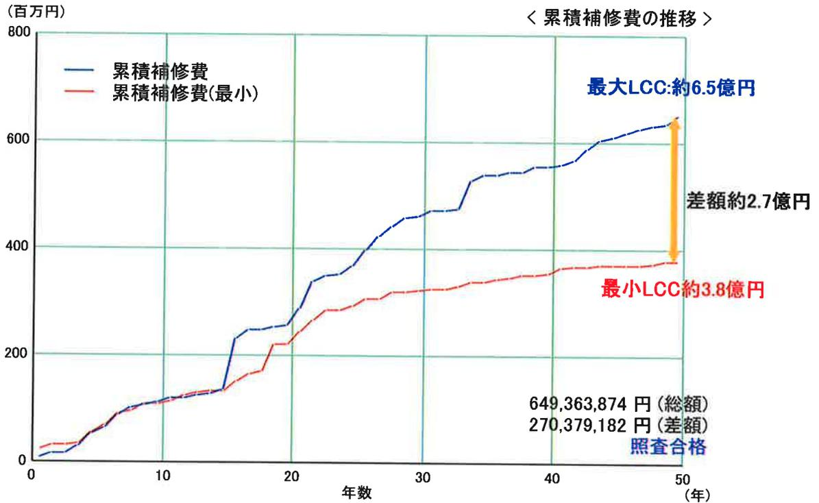
図 5-10 全橋梁の LCC 算定結果
