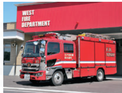
更新された水槽付き消防ポンプ自動車
