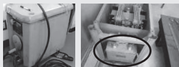
電気溶接機 電気溶接機の側面に取り付けられた低圧コンデンサー
